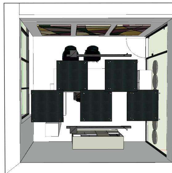
Pomieszczenie po adaptacji akustycznej – rzut z góry
