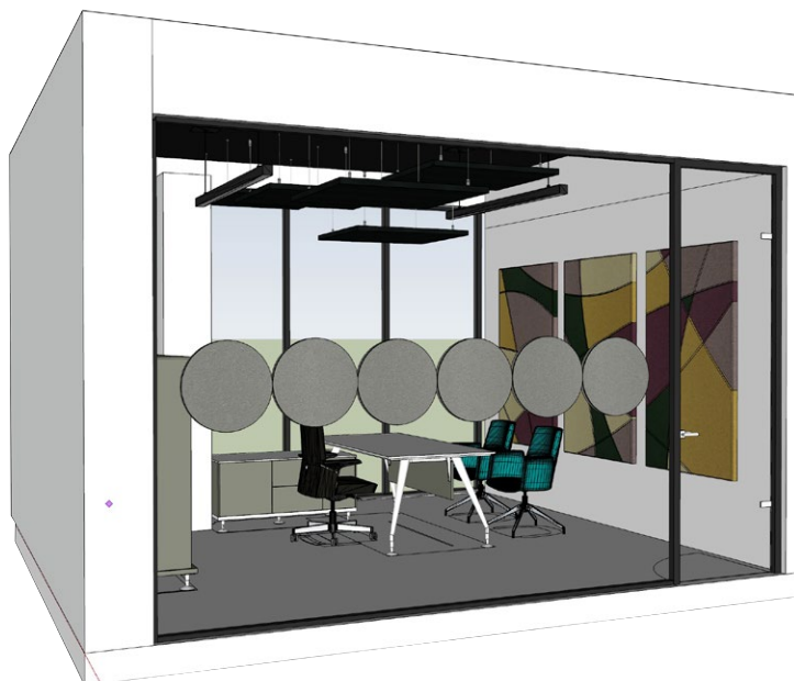
Pomieszczenie po adaptacji akustycznej
